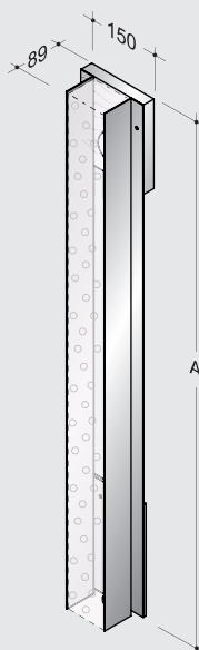
Telaio per applicare art. CAP.445.000T (CAP.445.MR0T.00), CAP.445.0000 (CAP.445.MR00.00) nelle pareti in muratura.
